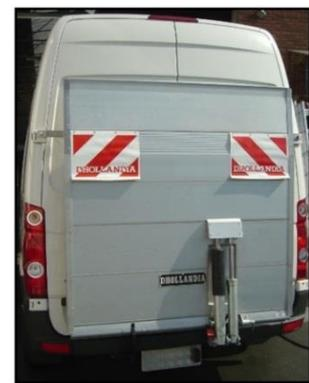
Ces hayons élévateurs fonctionnent tous hydrauliquement et sont équipés d'un système d'inclinaison automatique.
